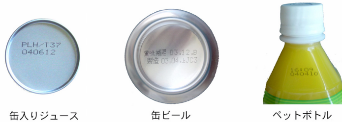
図 3.34 インクジェットプリンタによる賞味期限やロット No. の印字例
