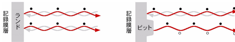
図 3.12 CD の記録膜層での反射と反射光の干渉
